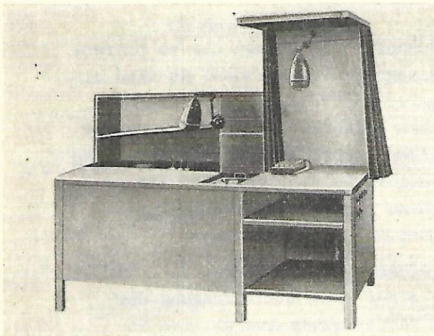
Bild 1.4 Anlage für das Fluoreszenzverfahren
