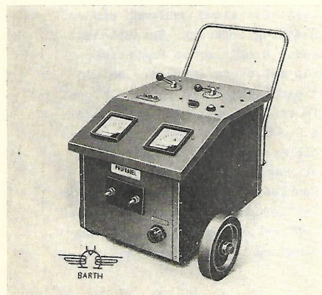
Bild 2.11 Fahrbares Rißprüfgerät Typ RGP Elektro-Barth, Dresden-Hellerau
