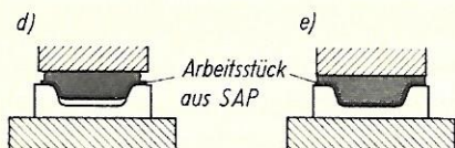
Bild 3.28 Schematische Darstellung des Dydzacking-Verfahrens zur Herstellung von Tiefziehteilen aus SAP [10]
